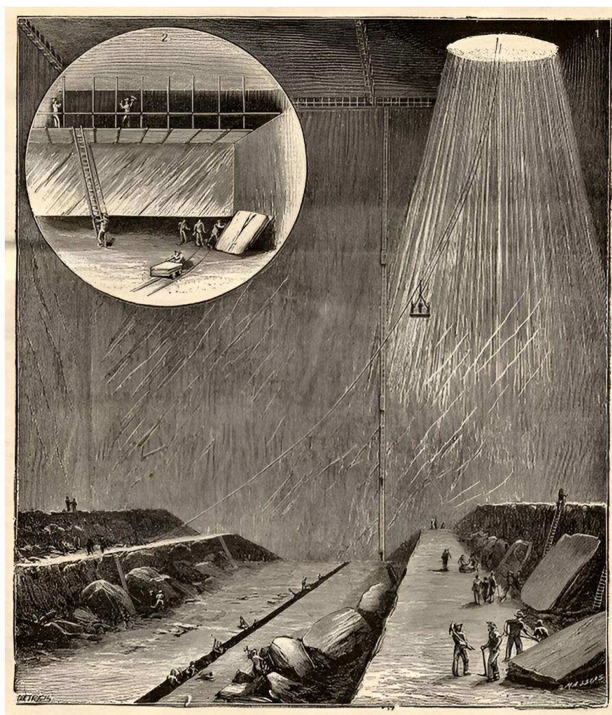
Figura 7. — Grabado de las minas históricas de Angers, Francia. Los bloques se tenían que elevar casi 100 metros desde el fondo de la mina hasta la superficie. Finales del siglo XIX.
