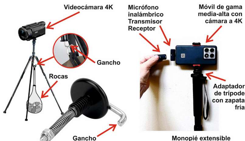
Figura 3. — Izda: Video-cámara handycam sobre trípode ligero de carbono. En el campo siempre encontramos rocas o pesos para estabilizar el trípode según se muestra en la figura . Dcha: Montaje ligero de monopí para montañismo fotográfico, móvil con cámara Leica a 8K y 4K y micrófono inalámbrico.
